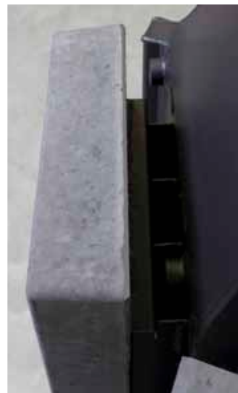
Einhängen der Speicherelemente an den Kühlrippen der Brennzelle.
