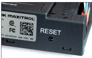
Рис. 16. Отверстие « RESET» - приемник
