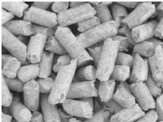
Hochwertige Holzpellets – Weißpellets ohne Schwarzpunkte (Rinde)
