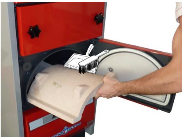
Reinigung des keramischen Verbrennungsraumes - Zylinders
