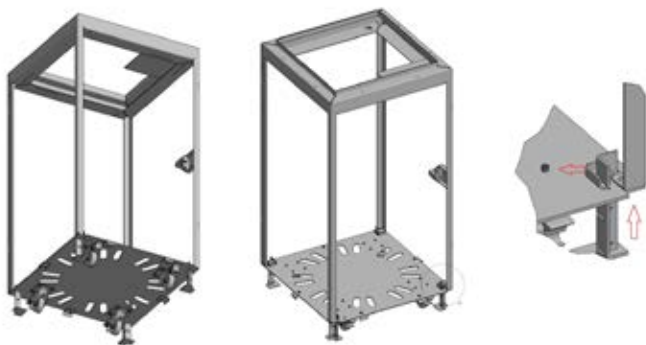
Abb. 4 Schema der Einstellung von Stützen
