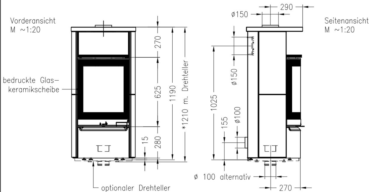
Bei Version mit Stahlverkleidung, seitliche Verkleidung einteilig!
